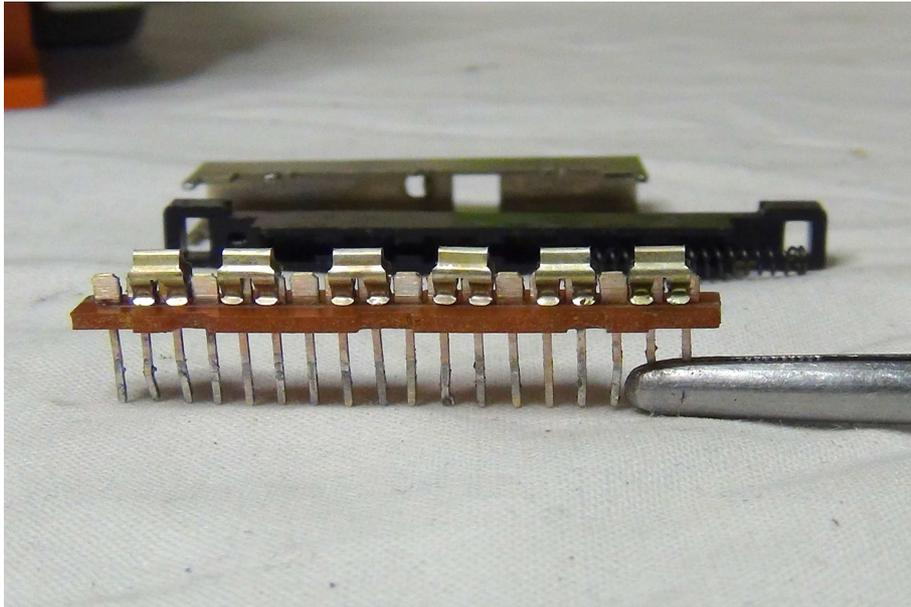
4) Repérer le sens de montage des pièces, puis poser la glissière noire sur la barrette munie des contacts. Positionner la cage métallique en forme de « U » sur cet ensemble.
